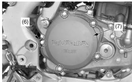
(6) болты кожуха сцепления (7) кожух сцепления
